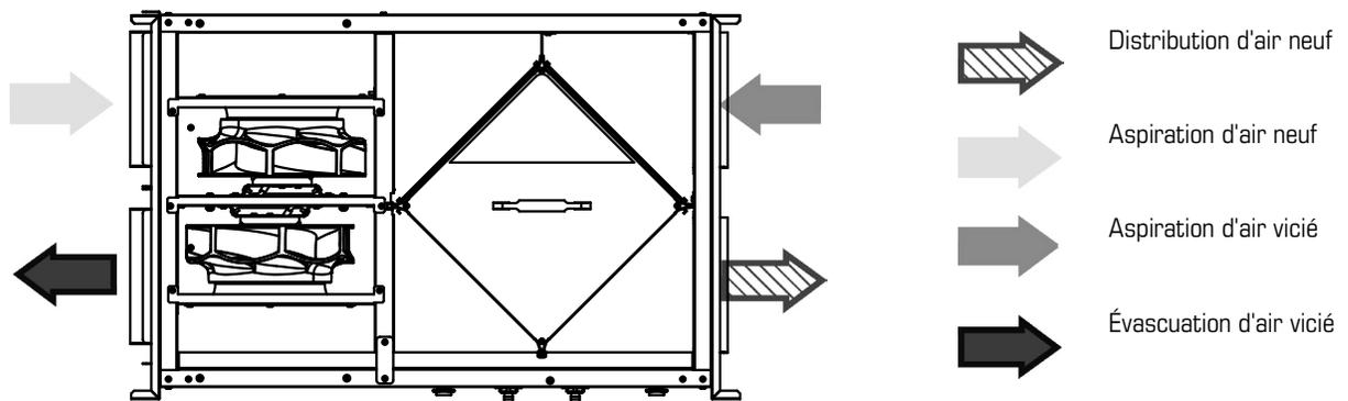
Réglage en usine. L'appareil peut être facilement inversé sur les lieux d'installation.
